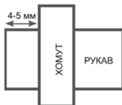
Рис. 6 Расположение хомута на рукаве
