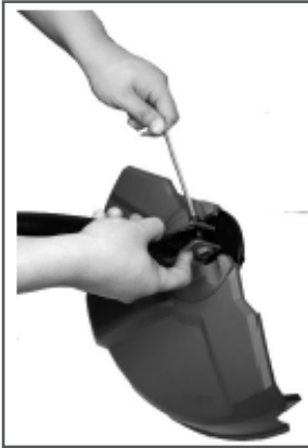
Рис. 3 Установка защитного кожуха
