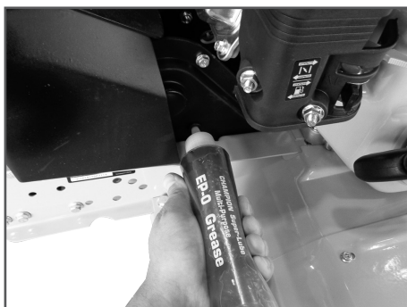
Рис. 26 Добавление смазки в редуктор
