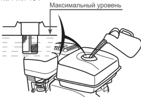
Рис. 13 Максимальный уровень топлива в топливном баке
