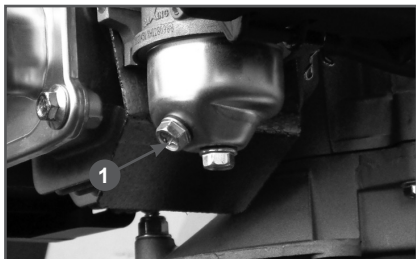
Рис. 22 Слив топлива с поплавковой камеры карбюратора 1. Болт
