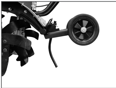
Рис. 19 Установка транспортировочной тележки и сошника в рабочее положение
