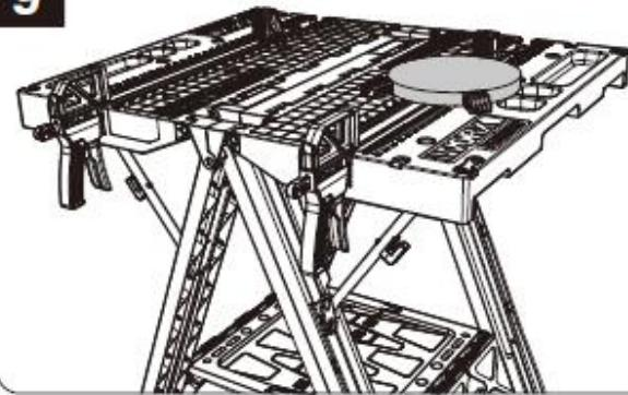
При работе используйте зажимные колодки и два быстродействующих зажима для различных вариантов зажима заготовки. (Рис. 6-9)
