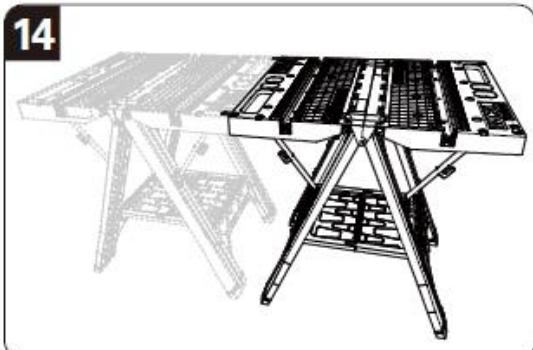
При необходимости, несколько рабочих столов могут быть соединены друг с другом боковыми или торцевыми сторонами при помощи специальных соединительных элементов. (Рис. 13-14)
