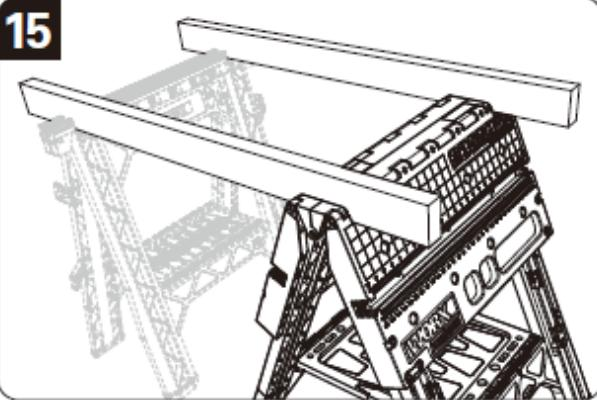
Чтобы использовать Pegasus в качестве козел, полностью раскройте ножки, пока лоток для инструментов не станет горизонтально. Он совместим с зажимными козлами производства нашей компании (не входят в комплект поставки). (Рис. 15)
