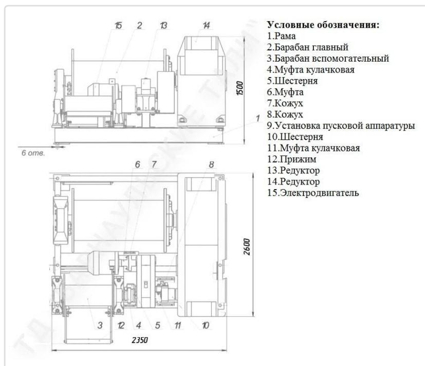
Лебедка электрическая специальная маневровая ЛЭМ-20 Э1 предназначена для передвижения железнодорожных вагонов на погрузочно-разгрузочных участках прирельсовых складов. Приведенные ниже технические характеристики и варианты комплектации могут изменяться со временем, и отличаться от информации, опубликованной на сайте. Чтобы уточнить описание, габаритные и присоединительные размеры, тяговое усилие, скорость навивки каната, обращайтесь к менеджеру.
