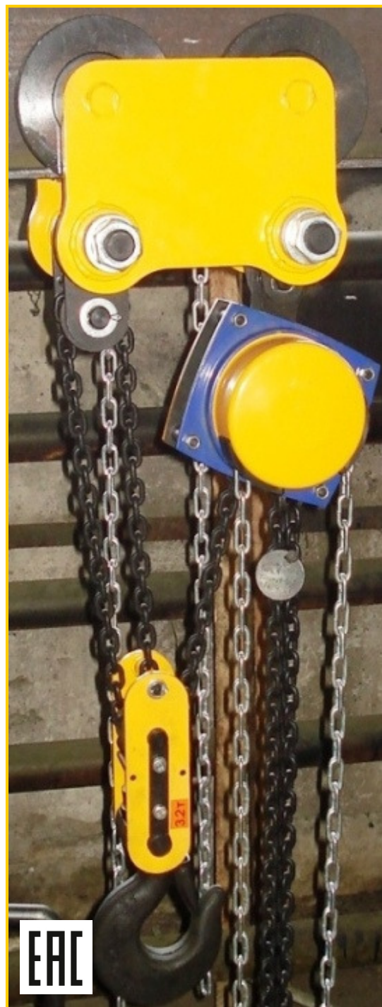
Таль передвижная ТРШБп-3,2 грузоподъемностью 3,2 тонны
