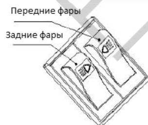
Рисунок 18. Кнопки включения/выключения фар
