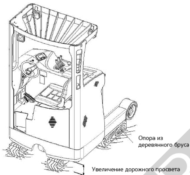
Рисунок 34. Положение ричтрака во время длительного хранения
