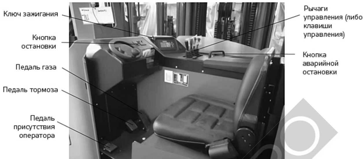
Рисунок 10. Основные устройства управления в кабине оператора
